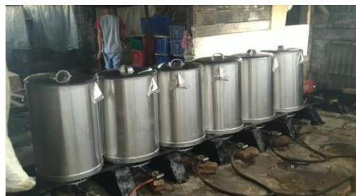
Gambar 3.6. Instalasi dan ujicoba kompor besi cor dua kran
