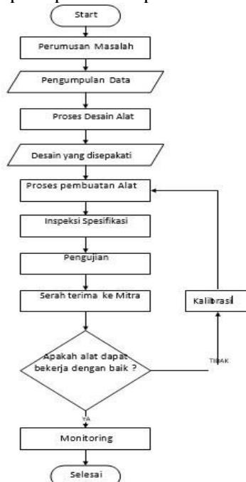
Gambar 2.1. Diagram alir tahapan pembuatan alat kukus ubi
