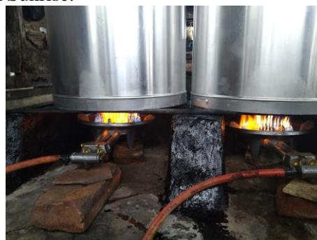
Gambar 3.5. Instalasi dan ujicoba kompor besi cor dua kran
