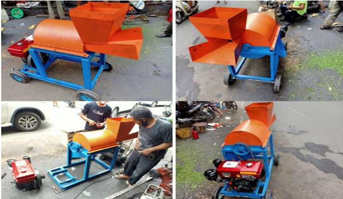
Gambar 3.1. Perangkat sederhana mesin pemotong atau pencacah
