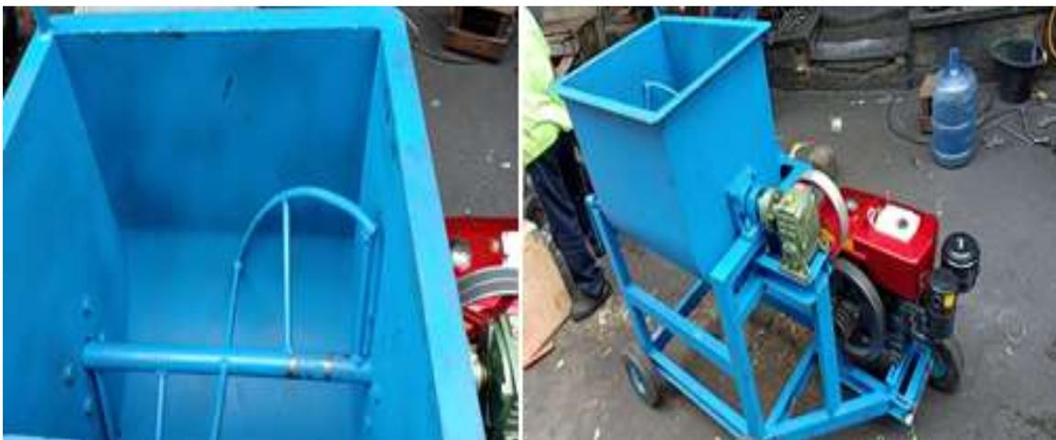
Gambar 3.2. Perangkat sederhana mesin pencampur bahan produksi pakan
