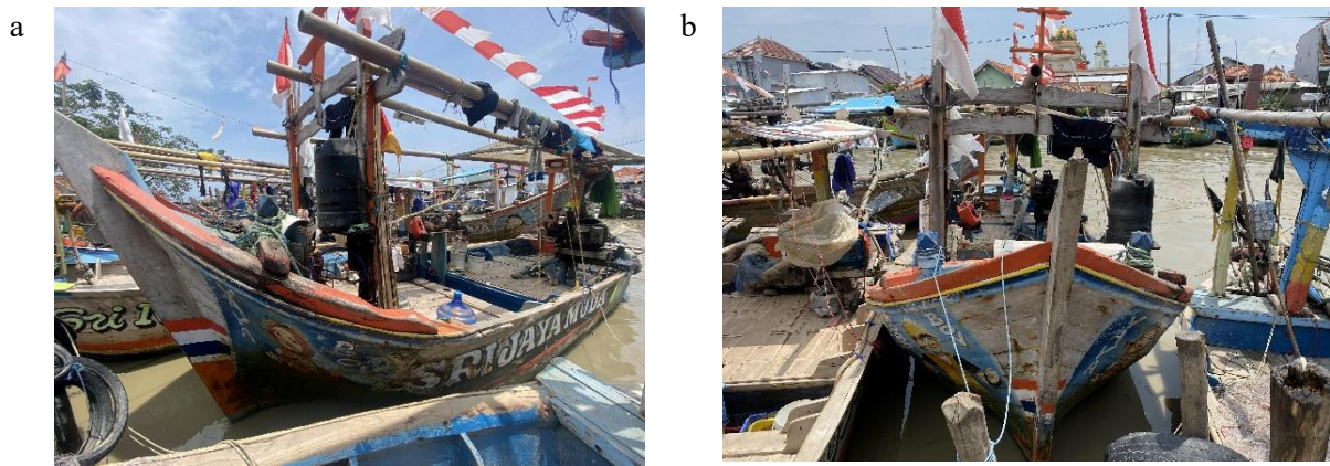
Gambar 3. Kapal penangkapan rajungan dengan bubu lipat; a) tampak samping; b) tampak depan
