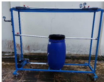
Gambar 12 Alat Uji Aliran Fluida Skala Laboratorium
