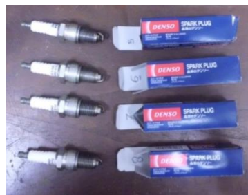
Gambar 4.6 Busi yang akan digunakan dalam pengujian saat menggunakan campuran bahan bakar premium dan hidrogen
