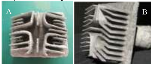
Gambar 1. Hasil benda cor a) dengan penambahan Cu dan b) tanpa penambahan
