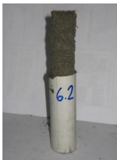
Gambar 4.1 benda uji dengan cetakan I
