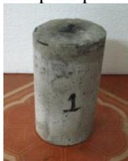
Gambar 3.15 Spesimen silinder
