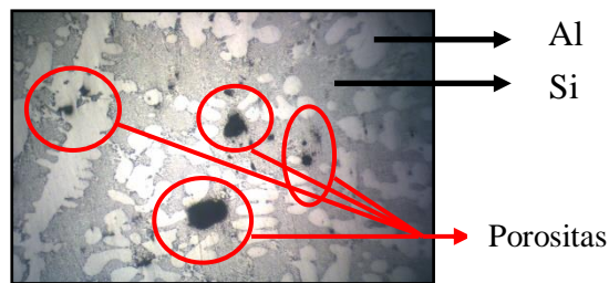
Gambar 4. Mikrostruktur spesimen yang terdeformasi plastis dengan 200 x pembesaran
