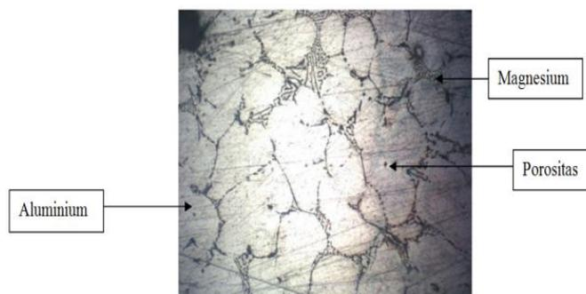
**Gambar 6** Mikrostruktur paduan aluminium ditempering Suhu 200<sup>0</sup>C
