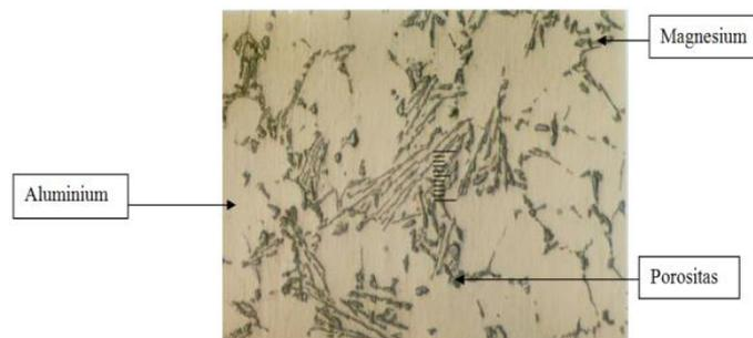
**Gambar 5** Mikrostruktur paduan aluminium yang tidak distempering
