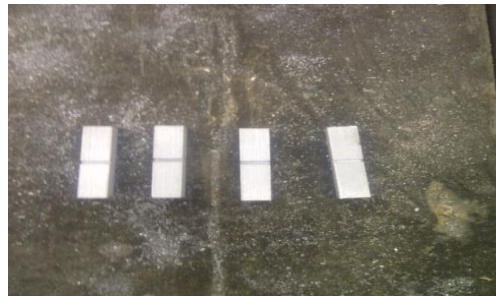
Gambar 8. Spesimen uji impact yang belum di uji
