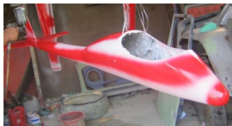
Gambar 3.6 tampilan hasil proses pengecatan tahap kedua
