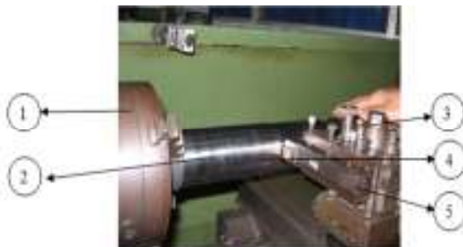
Gambar 3. Susunan Peralatan Penelitian Pengujian Pemesinan: (1) Pencekam benda kerja ( Chuck ) (2) Benda kerja (AISI 4140 (kekerasan 55 HRC)) (3) Dudukan pemegang pahat ( Tool Post ) (4) Pahat CBN (5) Pemegang Pahat ( Tool Holder )
