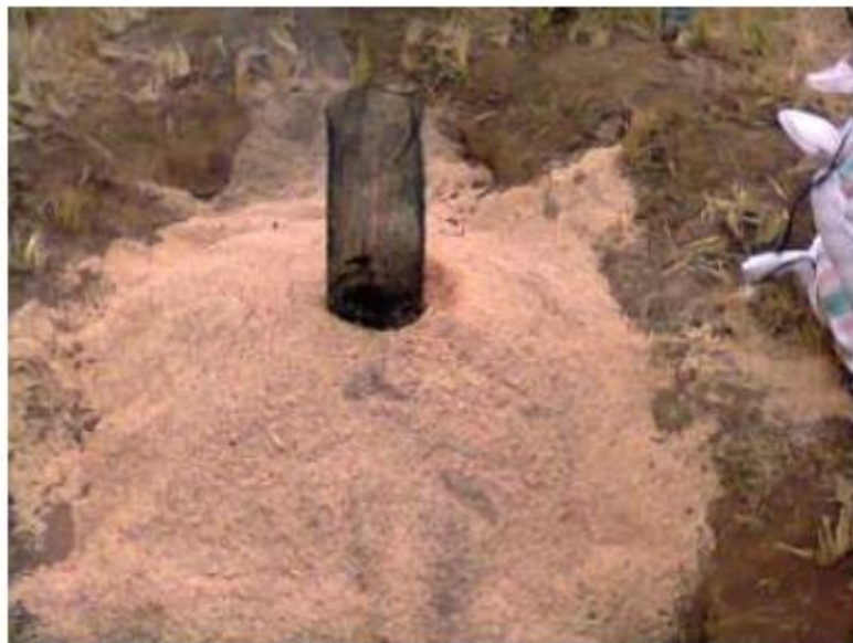
Gambar 4. Teknik Klin pada pembuatan Biochar sekam padi (Neneng et al. , 2015).
