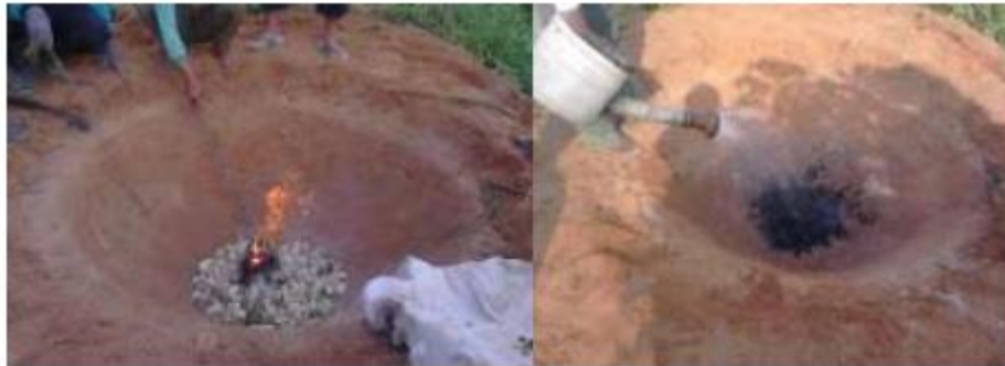
Gambar 5. Pembuatan biochar menggunakan Kontiki di KP Taman Bogo, Lampung Timur (Neneng et al. , 2015)
