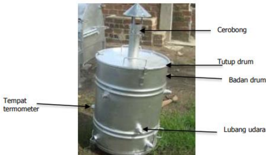
Gambar 2. Pirolisator dari drum (IPB) (Neneng et al. , 2015)
