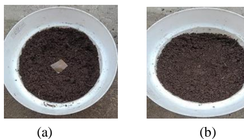
Gambar 4. Hasil analisis degradasi edible film konsentrasi filler 3% (a) Hari pertama (b) Hari ketujuh
