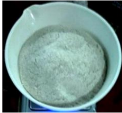
Gambar 2. Hasil kalsinasi serbuk cangkang telur bebek dengan menggunakan furnace
