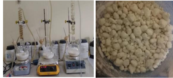
Gambar 3. Proses sintesis kalsium gliseroksida dengan sistem refluks
